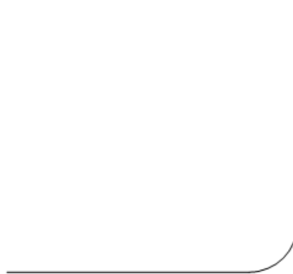
Abbildung 2: C^1 -stetige Kurve aus Strecken und Viertelkreis
