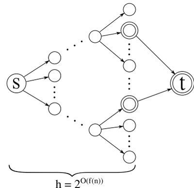
Mittels *dynamischem Programmieren* überprüft  $M_d$ , ob es einen Weg von  $s$  nach  $t$  mit  $k = |V|$  Zwischenknoten gibt.
