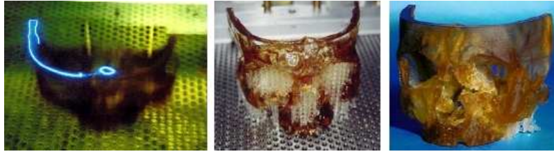
Abbildung 1: Stereolithographie: Laser beim Aushärten einer Schicht, Objekt vor der Härtung mit UV-Licht, nach der Aushärtung[1]
