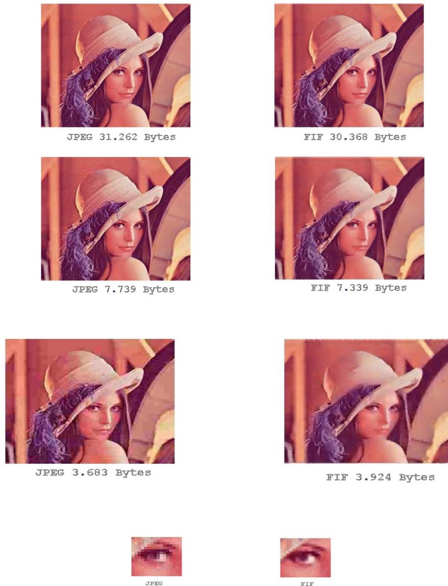
Abbildung 9: Die fraktale Kompression ermöglicht eine bessere Skalierung des Bildes. Beim Dekodieren nimmt man dazu ein grösseres Startbild.
