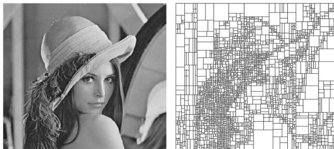
Abbildung 3: **HV-Partitionierung (Horizontal Vertikal Partitionierung)**
