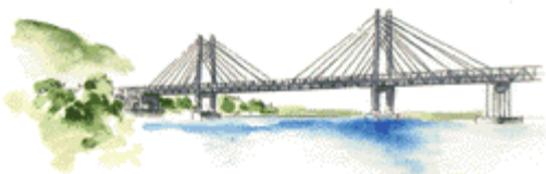
Schrägseilbr. (bis ~500m) Cable-stayed bridge
