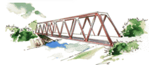
Fachwerkbr. (bis ~500m) Truss bridge
