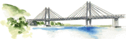
Schrägseilbr. (bis ~500m) Cable-stayed bridge
