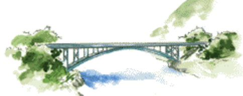
Bogenbr. (bis ~150m) Arch bridge
