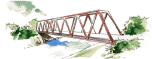
Fachwerkbr. (bis ~500m) Truss bridge
