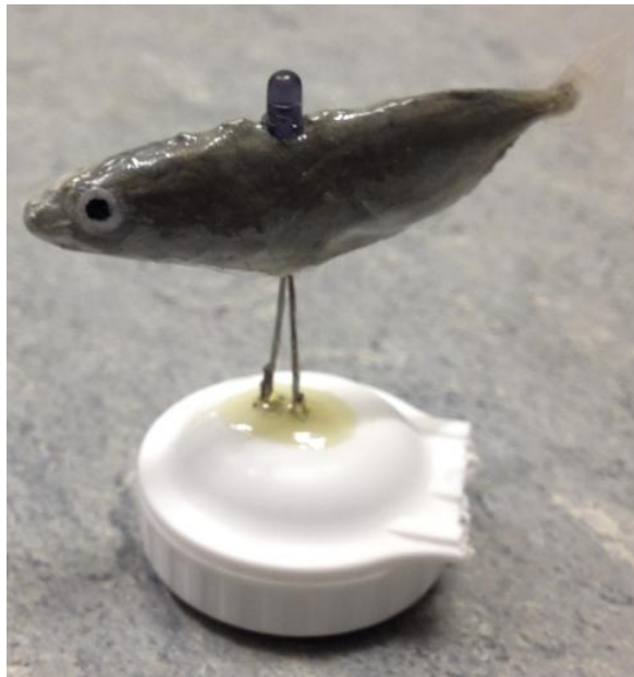
Abbildung 7: Der erste Prototyp des (Stichling-)Fisch-Replikates. Auf dem Rücken ist eine Infrarotlicht-LED zu erkennen. Die Batterie befindet sich in der wasserdichten Basis, die aus einem weißen Kontaktlinsenbehälter besteht. Die Anode und Diode der LED dienen als Verbindungsstück zwischen Nachbildung und Basis und sind innerhalb dieser mit einem Knopfzellenbatteriehalter verbunden.
