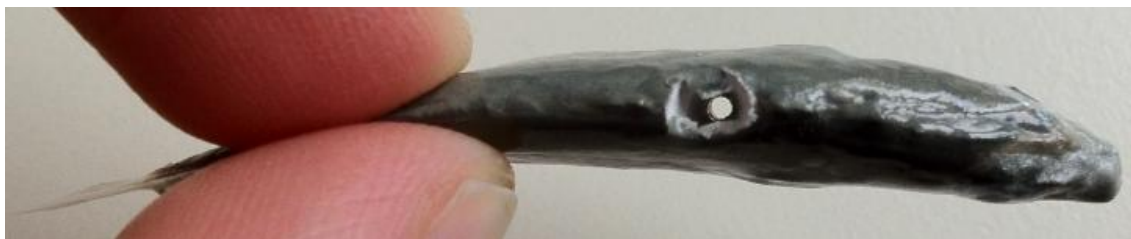
Abbildung 8: Zu sehen ist ein Fisch-Replikat, in dem ein Loch mit 2 mm Durchmesser gebohrt wurde.
