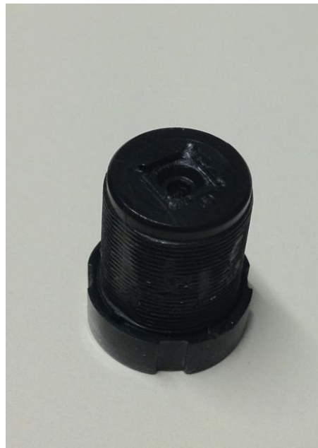
Abbildung 19: Eine standardisierte m12 Linse. Fixierfeld: 92^\circ . Die Linse hat keinerlei Filter.
