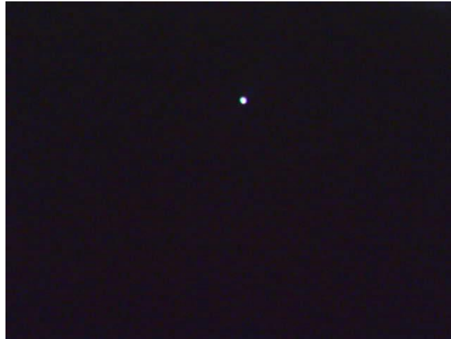
Abbildung 22: Kamerabild mit Infrarotlicht-Passfilter bei guter Raumhelligkeit. Eine klar leuchtende Infrarotlicht-LED ist zu sehen. Die anderen Lichtstrahlen werden herausgefiltert.
