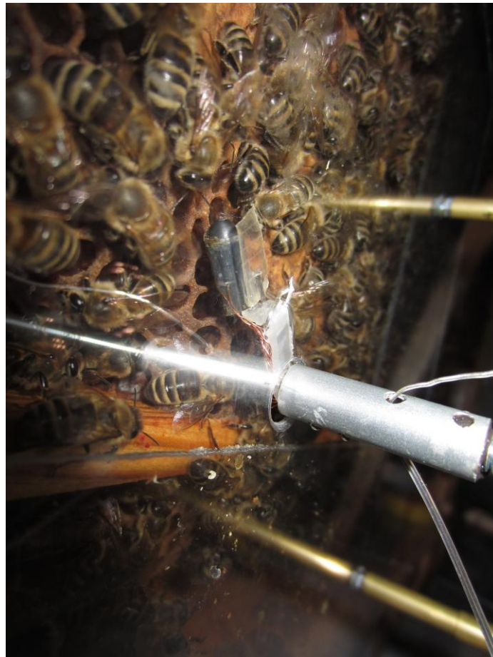
Abbildung 4 [18]: Der finale Prototyp der an der Freien Universität entwickelten Roboterbiene. Das Bienen-Replikat (sichtbar in der Mitte zwischen den Bienen) wird vom Roboter (rechts im Bild) gesteuert.
