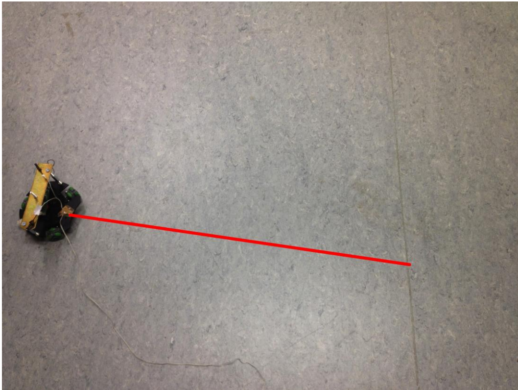
Abbildung 2: Links ist der Roboter zu erkennen (Durchmesser: 170 mm). Die rote Linie stellt die Trajektorie dar, die abgefahren werden soll.
