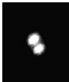
Abbildung 44: Durch Erhöhung der Belichtungszeit der Kamera verschmelzen zwei LEDs zu einer.
