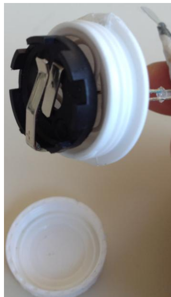
Abbildung 11: Die aufgeschraubte Basis. Im inneren ist der verwendete Knopfzellenbatteriehalter zu erkennen.
