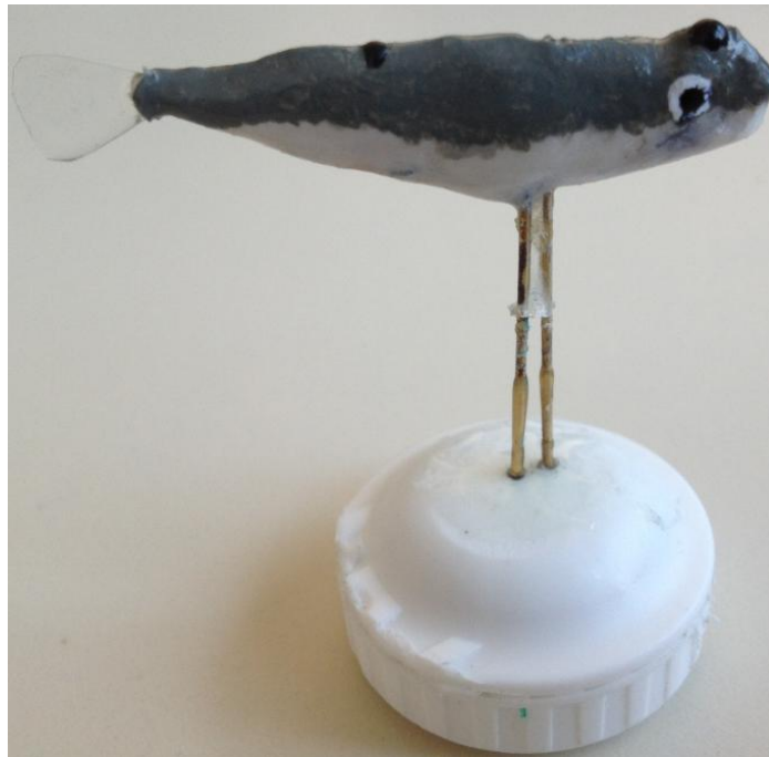
Abbildung 10: Der zweite Prototyp mit Basis. Oben sind zwei Infrarotlicht-LEDs zu sehen, die leicht aus dem Oberkörper des Replikates herausragen. Aus dem Unterkörper dringen zwei Kupferstangen, die in der Basis stecken, heraus. Diese dienen als Verbindungsstück zur Basis und leiten gleichzeitig den Strom in die LEDs.
