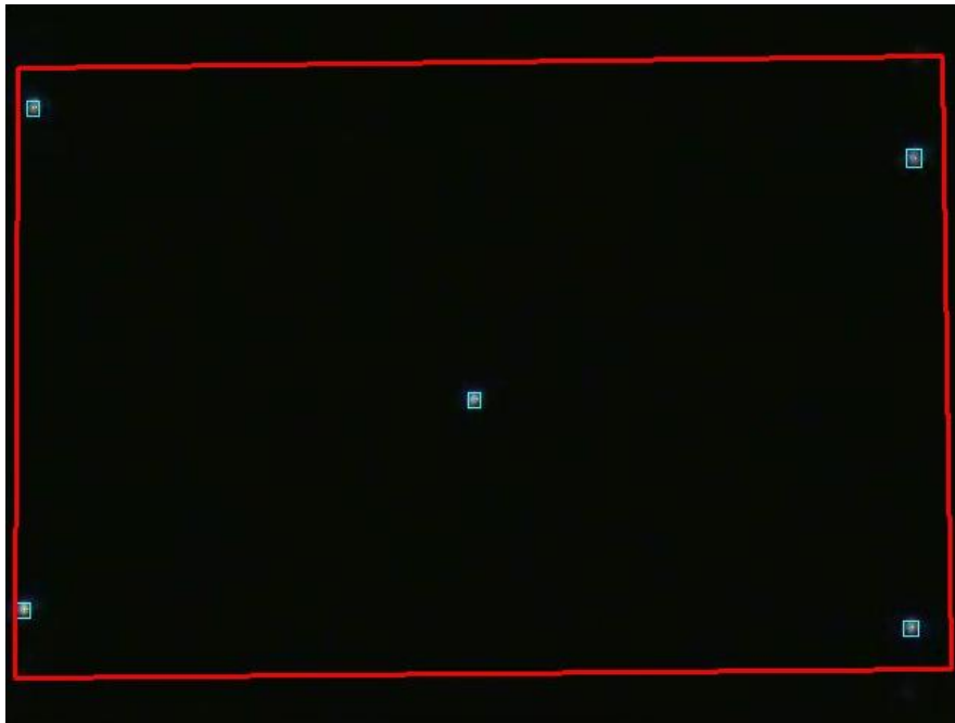
Abbildung 37: Gefundene LEDs (Zusammenhangskomponenten) im rektifizierten Bereich.
