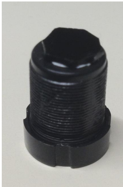
Abbildung 21: Dieselbe Linse aus Abbildung 19 mit einem aufgeklebten Infrarotlicht-Passfilter.
