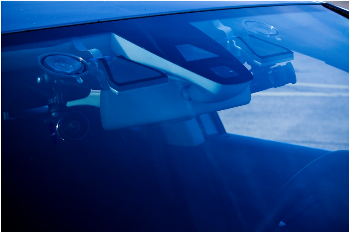
Abb. 2: Stereo Kamerasystem an der Windschutzscheibe von MadeInGermany
