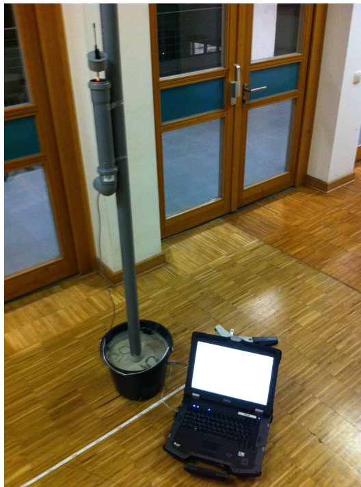
Abbildung 3.12 Anfordernder Sensorknoten im Versuchsaufbau des Innenraumexperimentes
