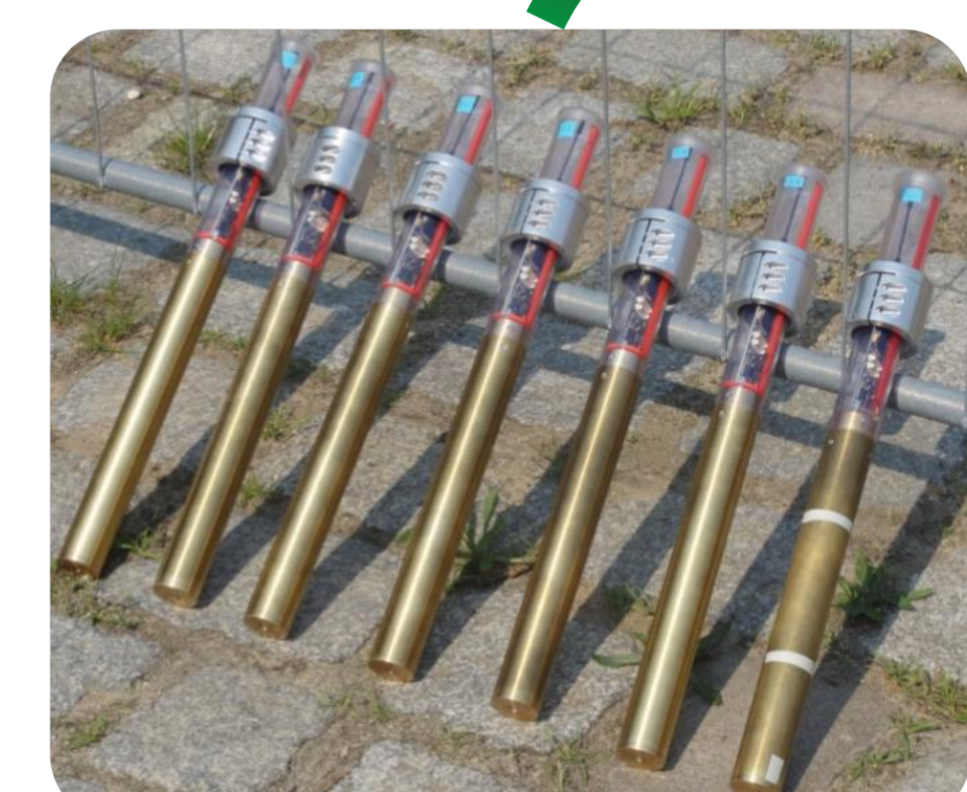
Sensorknoten mit Gehäuse und Sicherungsklemme
