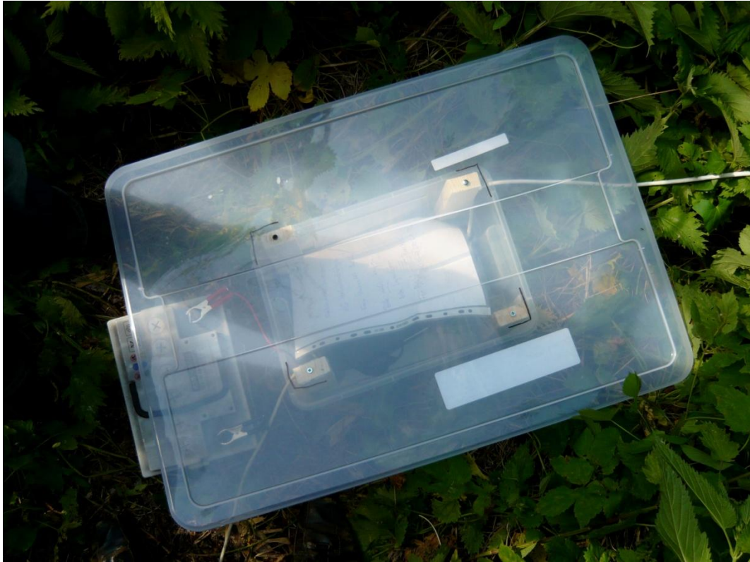
Abbildung 14: Netbook-Komponente im Feld, Gehäuse geschlossen
