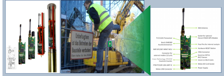
a) Evolutionäre Entwicklung b) Anwendung: Einbruchserkennung c) AVS-Extrem Board + Passgenaue Gehäusebauform für den Bauzaun mit 4 x 1,5V D-Zellen (ca. 18.000 mAh) + Witterungsbeständiges Material: Makrolon + ARM7 basierter Prototyp mit Bosch Beschleunigungssensor, ARM7 MCU, Chipcon CC110x, SH111 Temperatursensor + Luftfeuchtesensor und SD-Karte
